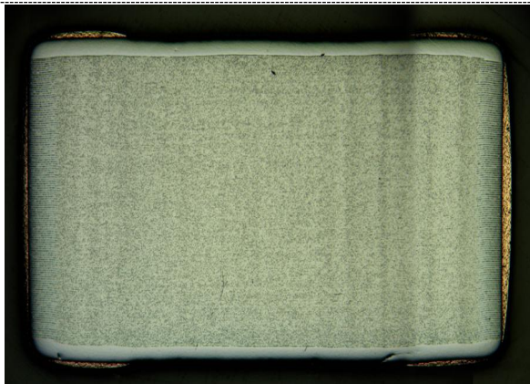
#1 样品-电极间距 L=4.14 \mu\text{m}
